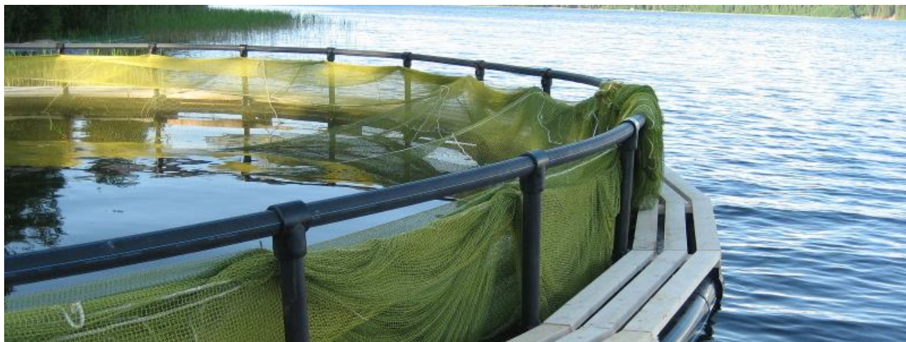
Рисунок 14 – Морской садок на основе гибкого понтона
