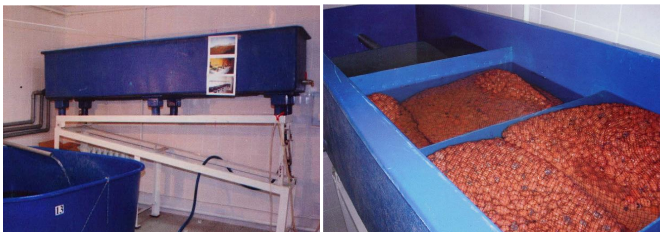
Рисунок 40 – Биофильтр с керамзитным наполнителем
